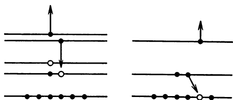
Рис. 5.14. Возможные автоионизационные переходы: слева — после возбуждения двух внешних электронов, справа — после возбуждения одного внутреннего электрона.
